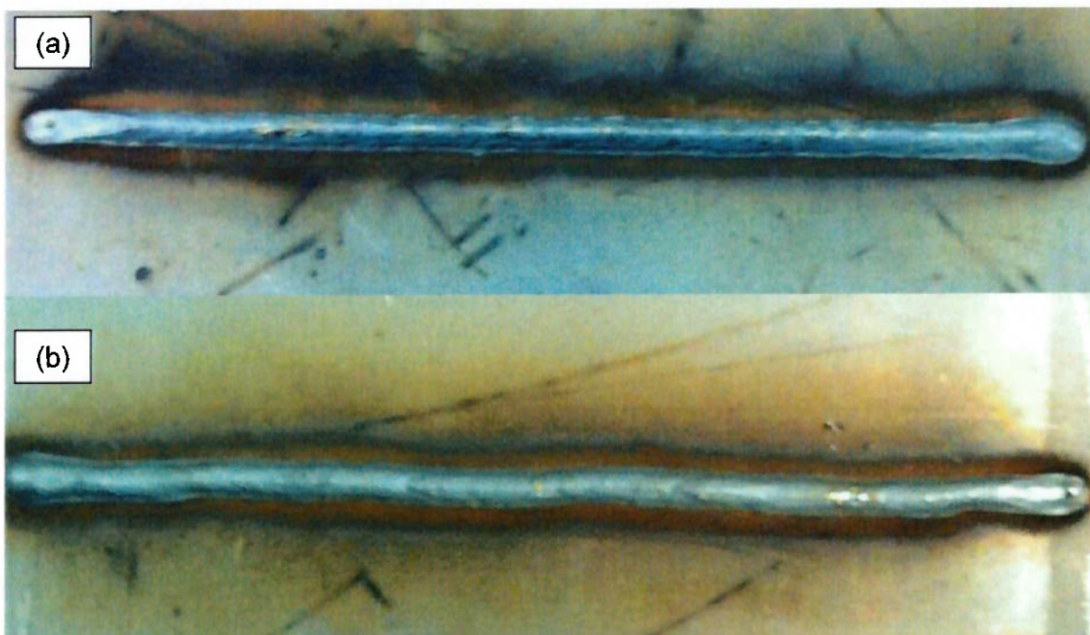
Figura 5.3 - Comparação visual entre os cordões de solda, utilizando-se parâmetros de 242 A e 26,4 V; (a) arame com cobertura de cobre, (b) arame sem cobertura de cobre
