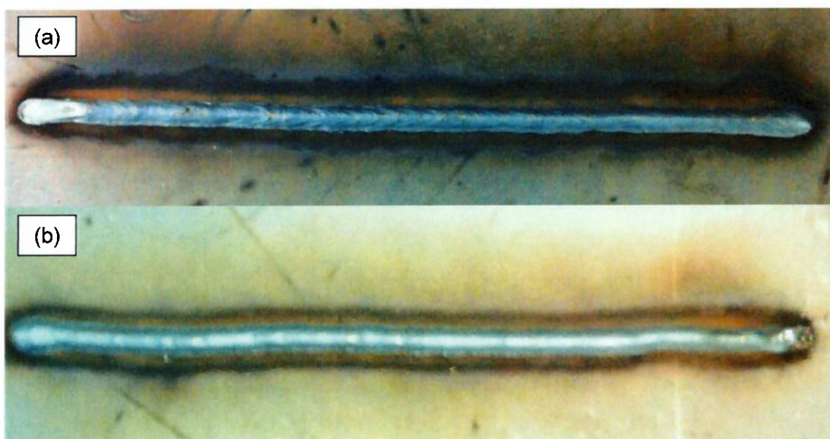
Figura 5.1 - Comparação visual entre os cordões de solda, utilizando-se parâmetros de 220 A e 24 V; (a) arame com cobertura de cobre, (b) arame sem cobertura de cobre
